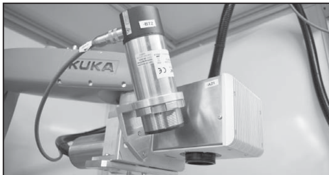
Instalovaný laser Solaris FLS na robotu Kuka pro laserové svařování plastů.
